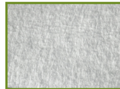
Figure 4 – Photo détaillée d'un géotextile non tissé
