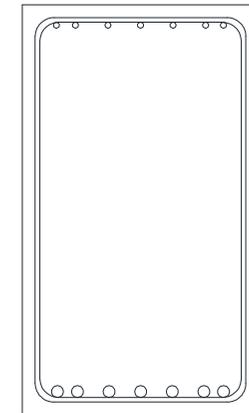
EE4:  $C_{\text{nom}} = 50 \text{ mm}$
