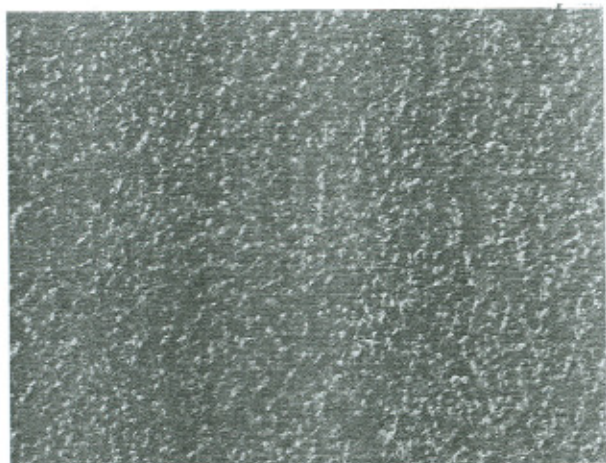
Fig. A1.5 — Bouchardé (taille mécanique).
