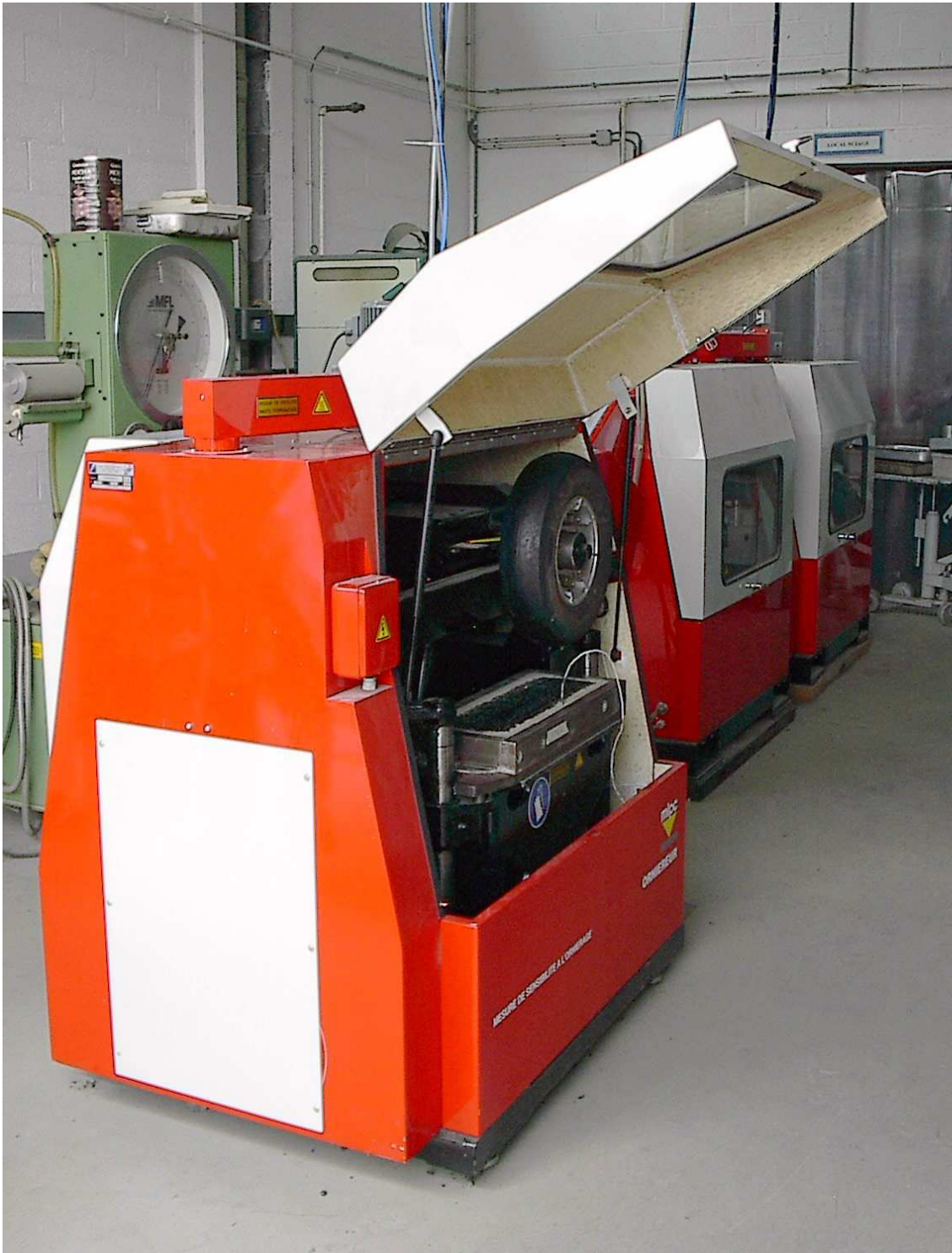
Fig. 54.18/2 : Simulateur de trafic avec une roue en acier
