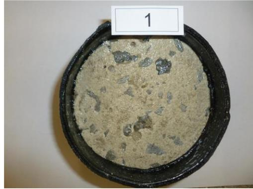
fig. 2: éprouvette avec rebord en feuille bitumineuse
