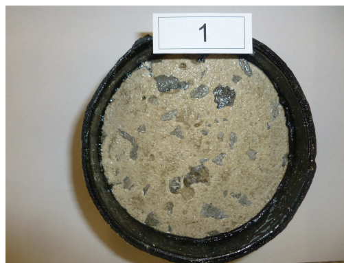
fig. 2: éprouvette avec rebord en feuille bitumineuse
