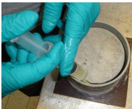
fig. 1: éprouvette avec rebord en PVC
