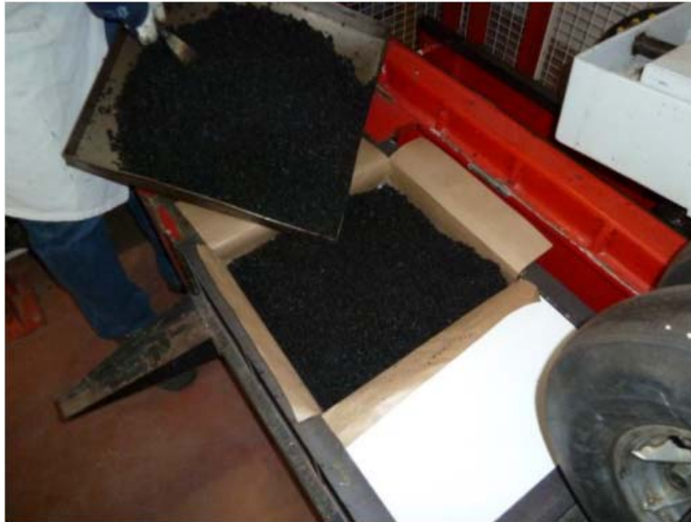
Figure E : Application de la couche de surface d'asphalte sur l'échantillon
