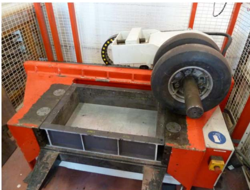
Figure A : Exemple de la machine de compactage de plaque avec moule, pour compactage d'asphalte selon la norme NBN EN 12697-33
