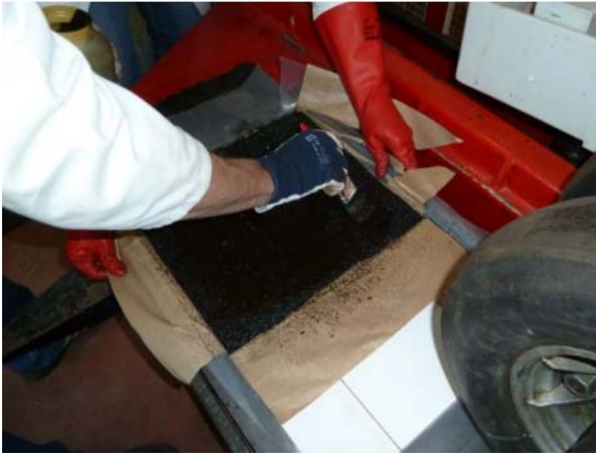
Figure C : Application couche émulsion tack coat sur l'échantillon
