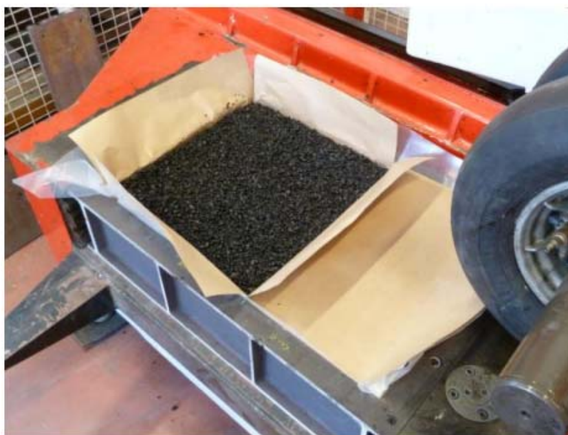
Figure B : Echantillon après compactage de la couche de sol asphalte (note : à droite dans le moule pas d'asphalte pour d'excellents renforts transversaux)
