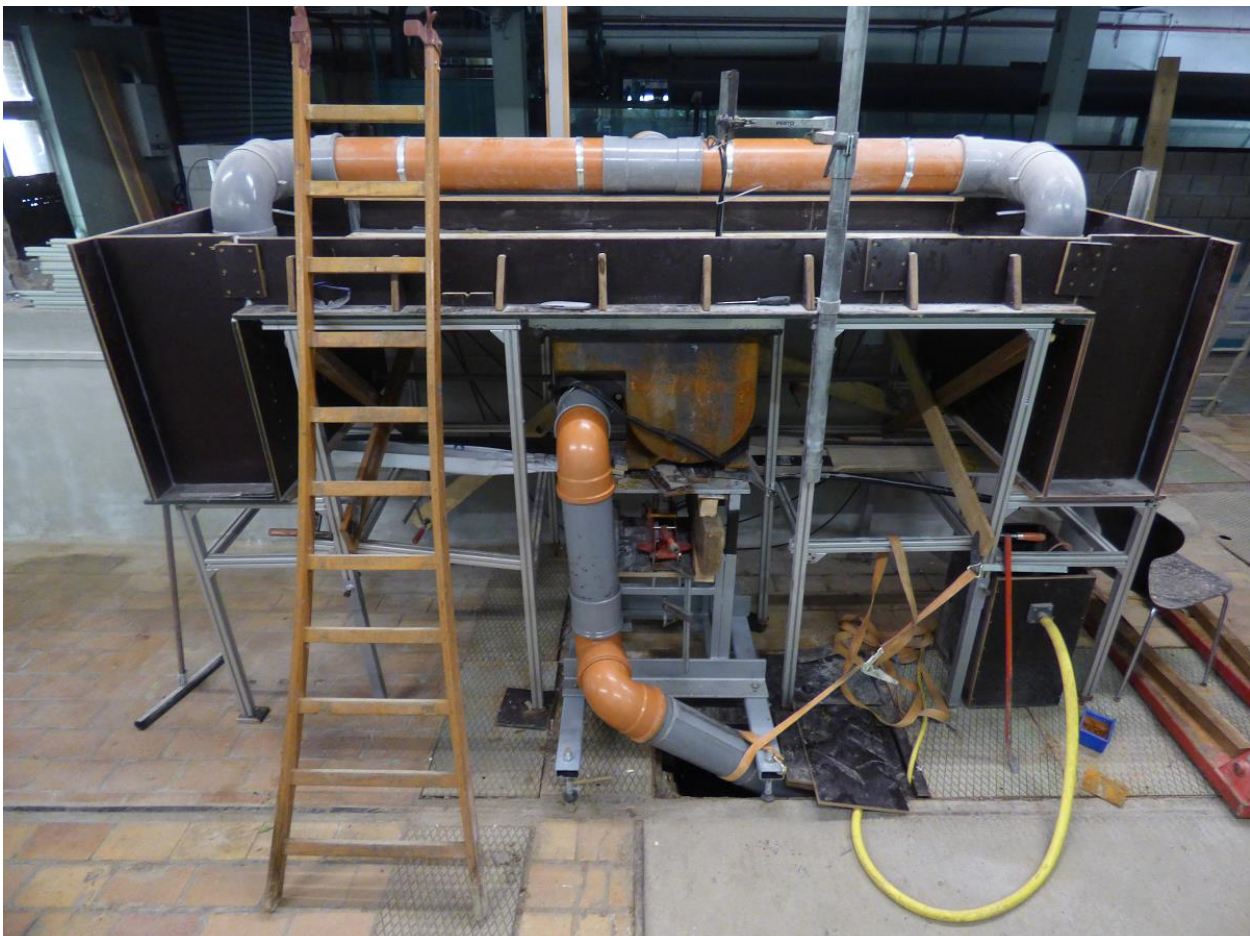
Photo 1 – Vue de face de la configuration d'essai (avaloir en fonte).
