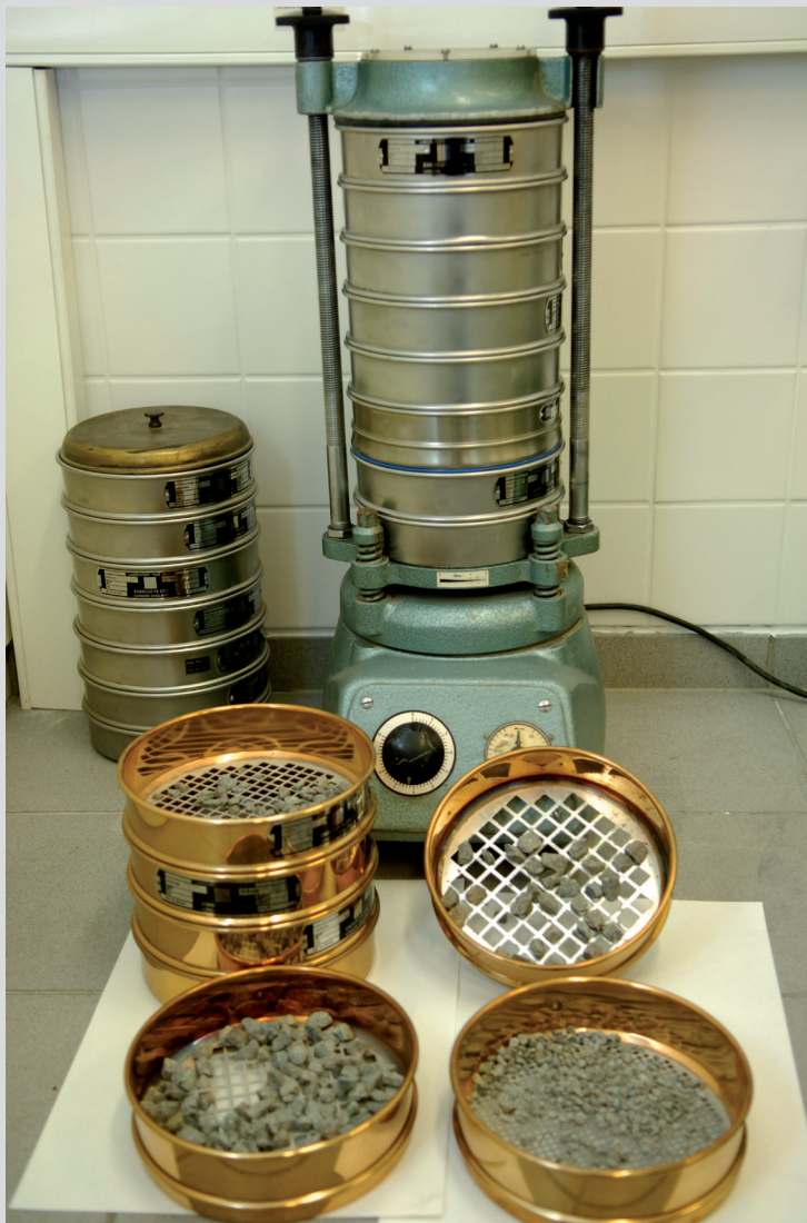
Tamiseuse vibrante. © SPW-Direction de l'Édition
