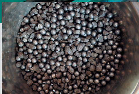
← Appareil Micro-Deval. © SPW-Direction de l'Édition
