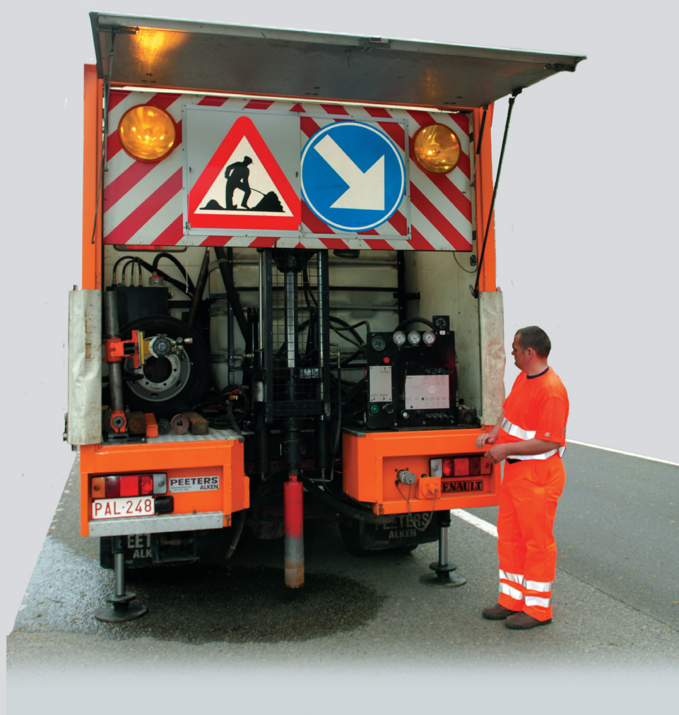
← Carotteuse sur camion. © SPW-Direction de l'Édition
