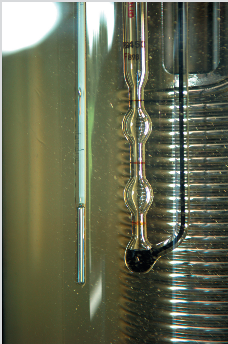
← Bain thermostatique et viscosimètre capillaire de type Cannon-Fenske.
