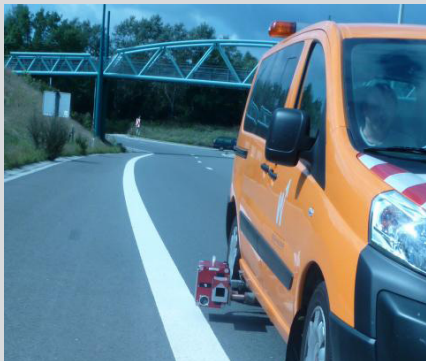
Photomètre placé à droite du véhicule © SPW-Direction de la Recherche et du Contrôle routier
