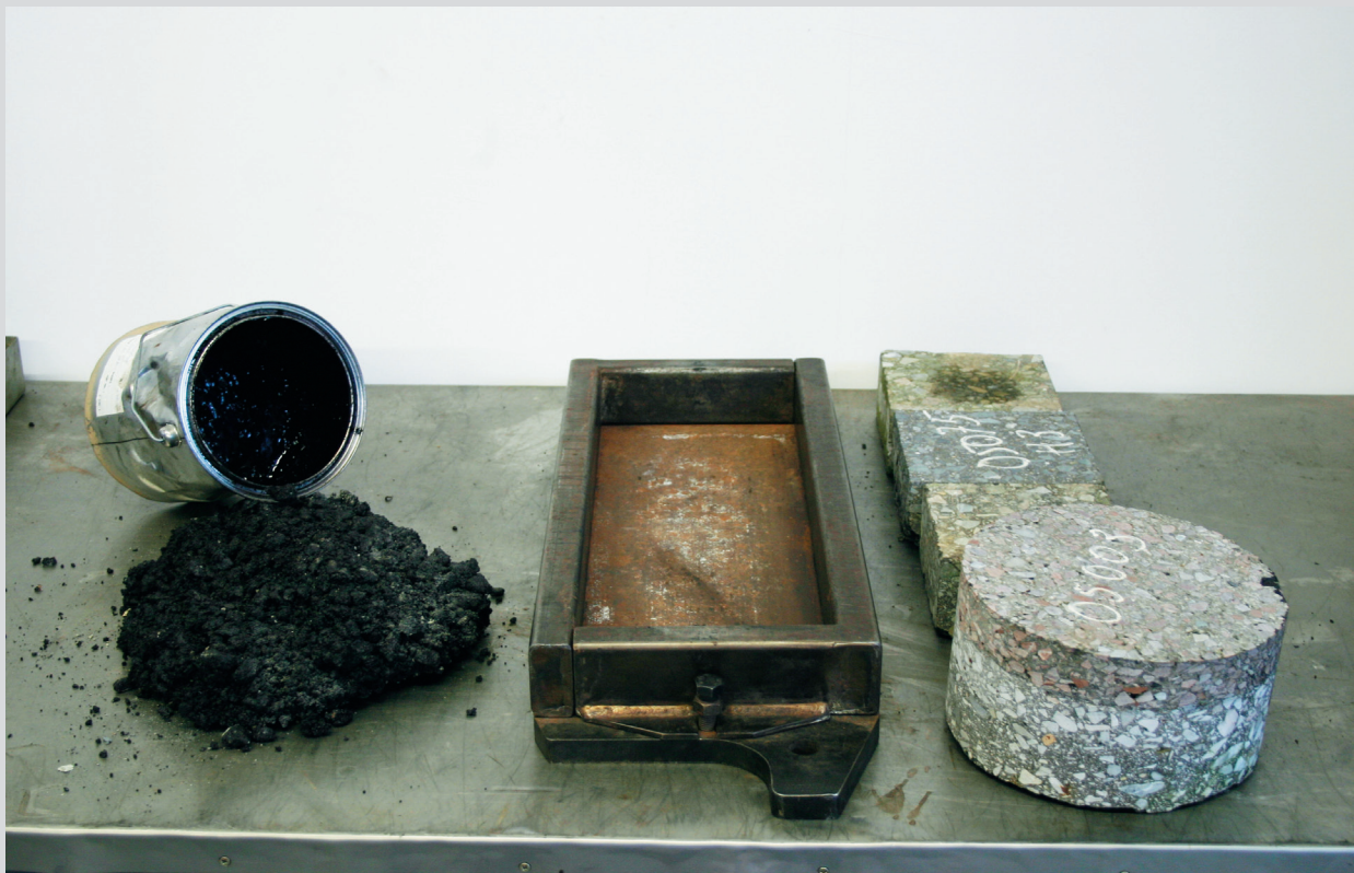
← À gauche, le vrac ; au centre, le moule vide ; à droite, les carottes pré-sciées. © SPW-Direction de la Recherche et du Contrôle routier
