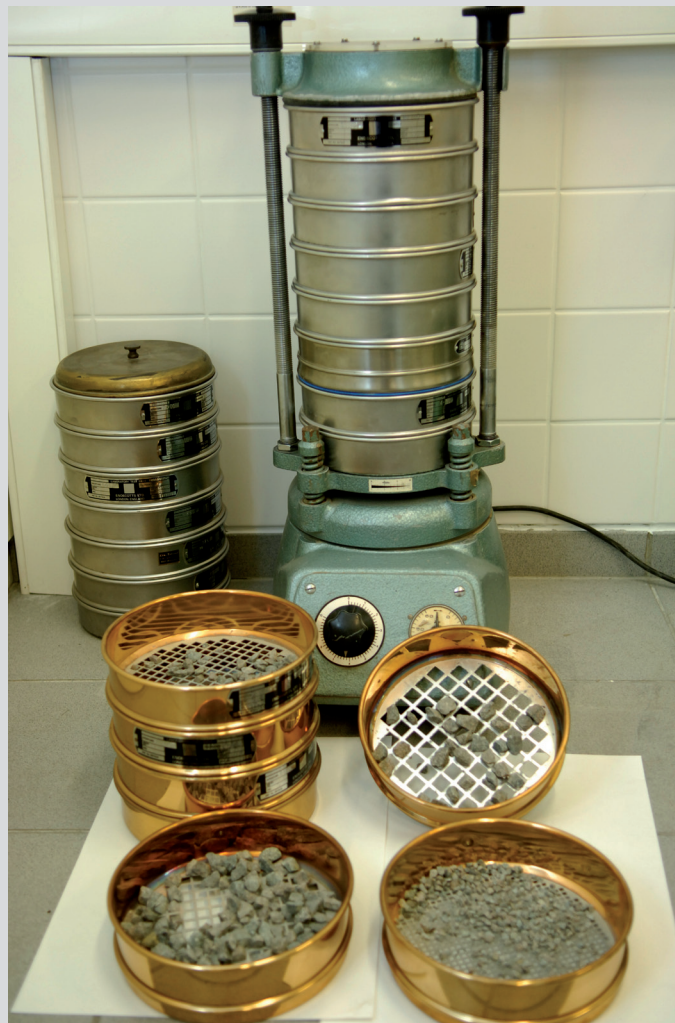
← Série de tamis à ouvertures décroissantes sur dispositif vibrant. © SPW-Direction de l'Édition
