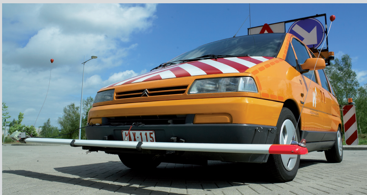
Transversoprofilomètre à ultrasons. © SPW-Direction de l'Édition
