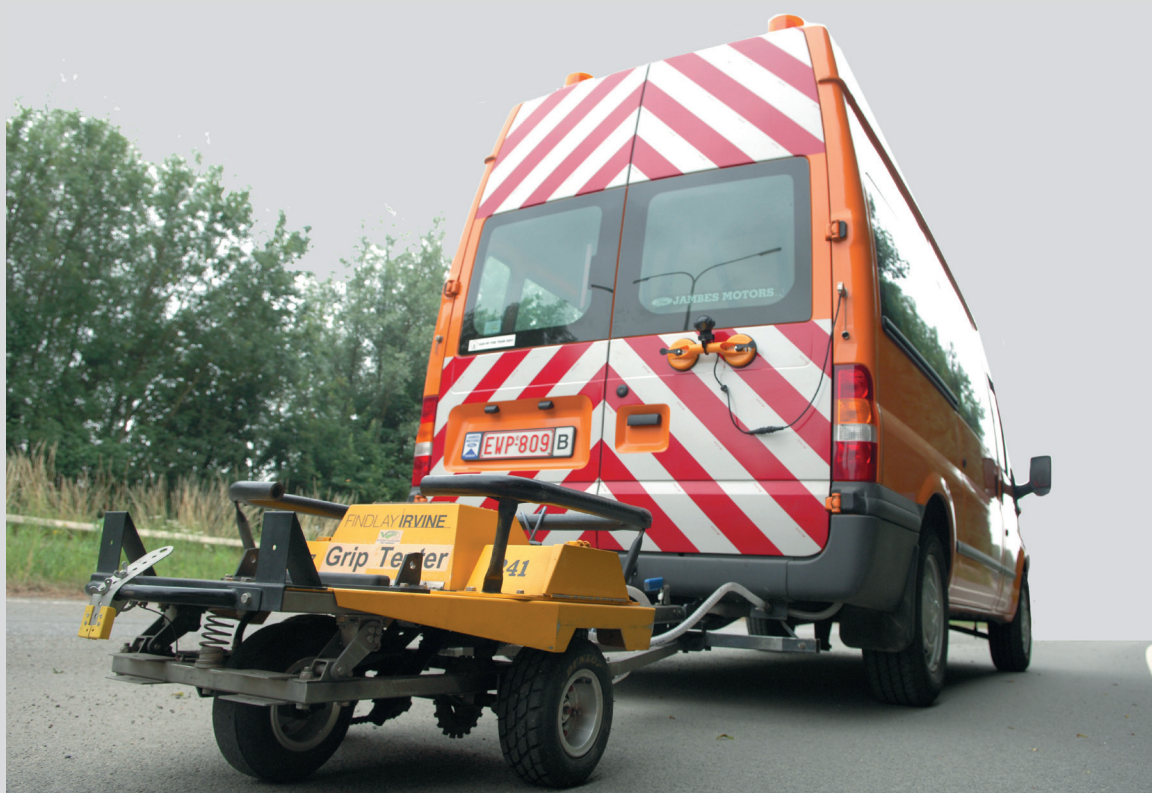
← Le Grip Tester. © SPW-Direction de l'Édition
