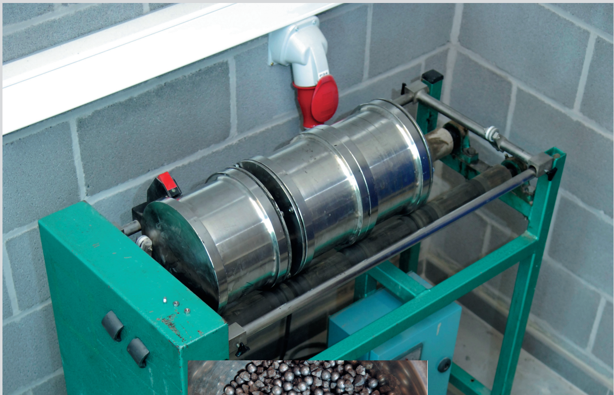
← Appareil Micro-Deval. © SPW-Direction de l'Édition
