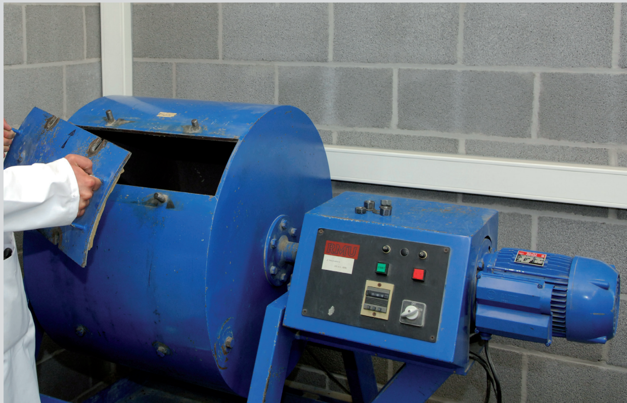
← Machine « Los Angeles ». © SPW-Direction de l'Édition
