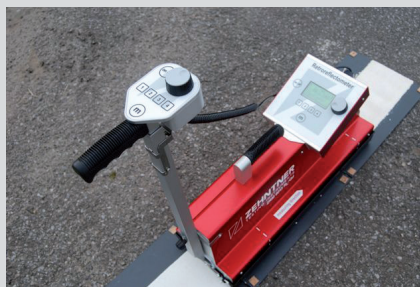
← Photomètre de type ZRM 6013 Zehntner © SPW-Direction de la Recherche et du Contrôle routier
