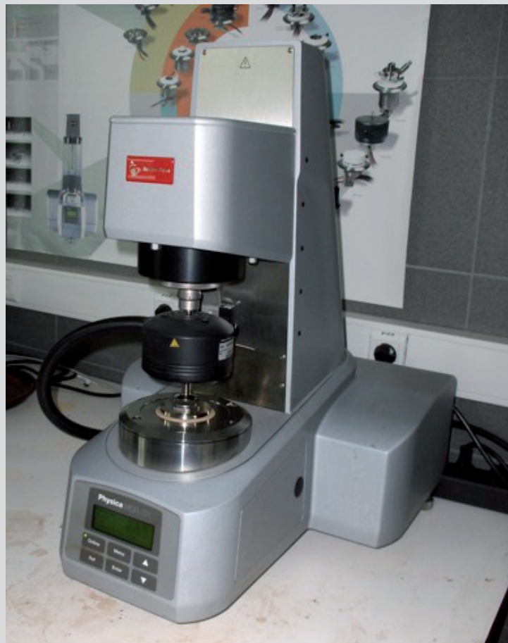
Le rhéomètre DSR.
