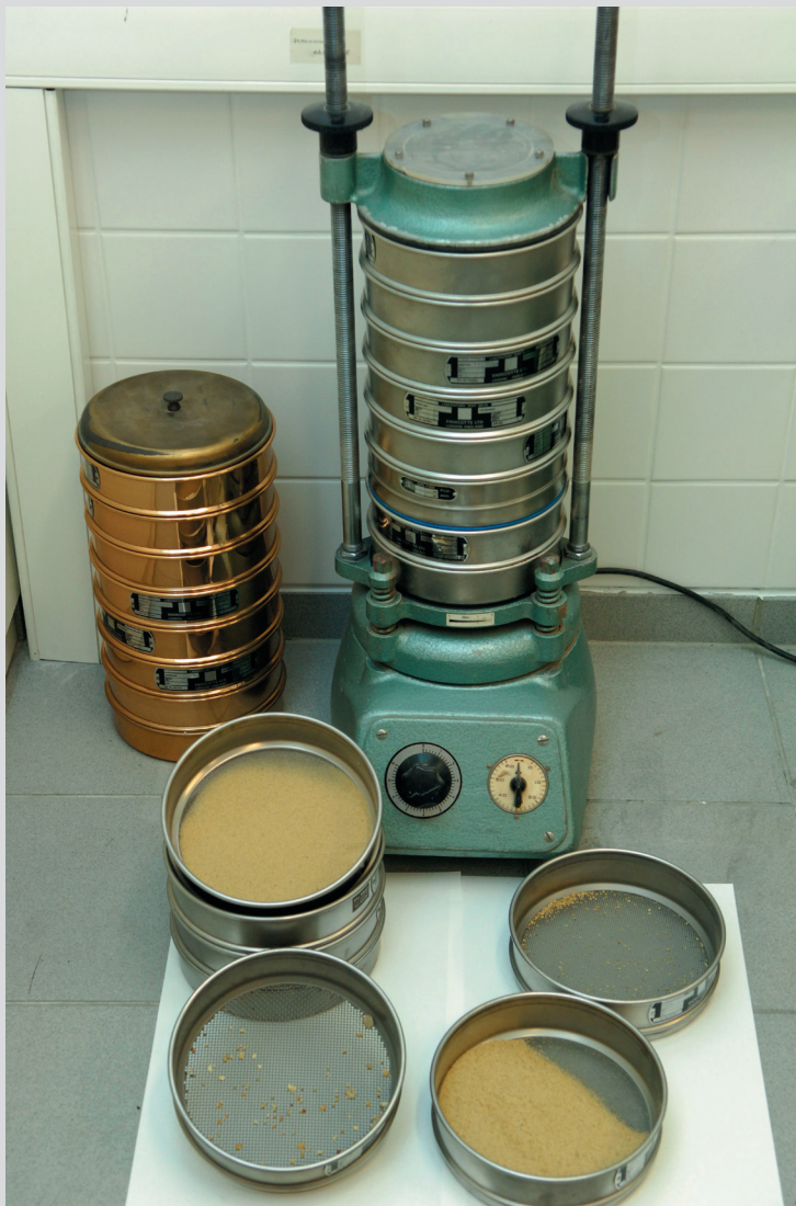
Tamiseuse vibrante. © SPW-Direction de l'Édition
