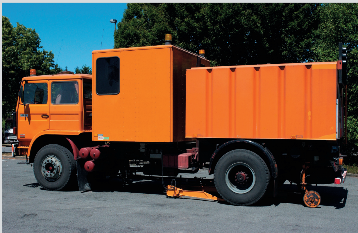
← Le déflectographe Lacroix. © SPW-Direction de l'Édition
