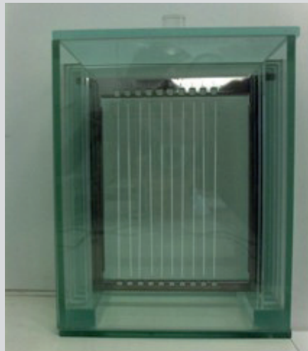
← Tiges de silice sur leur support et dans une enceinte d'élution. © SPW-Direction de l'Édition
