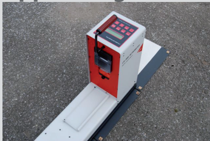
← Photomètre de type LTL 2000 Delta © SPW-Direction de la Recherche et du Contrôle routier
