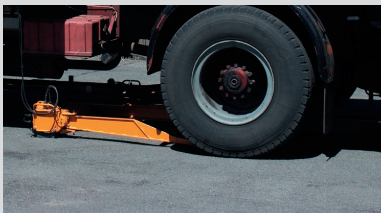
← Le déflectographe Lacroix. © SPW-Direction de l'Édition
