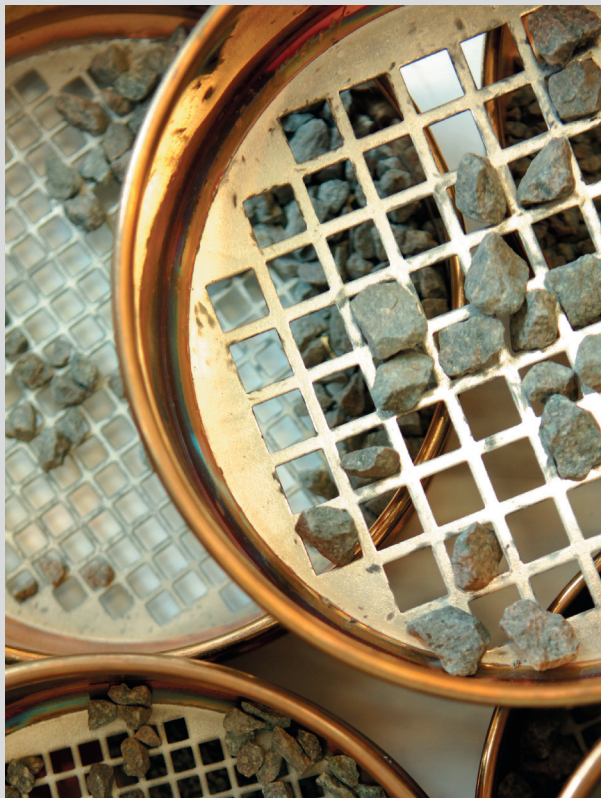
← Tamis d'essais à mailles carrées et grille à fentes parallèles. © SPW-Direction de l'Édition
