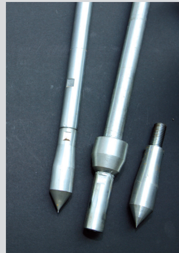
Pointe de type "CRR" - Angle de pointe 60° ; section 5 cm 2 © SPW-Direction de l'Édition
