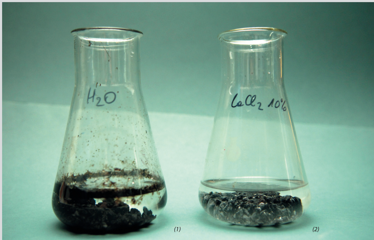
← Comparaison du désenrobage sous l'action de l'eau à 100 °C (1) et d'une solution saline (2). © SPW-Direction de l'Édition
