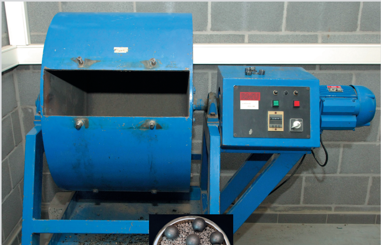
← Appareil Los Angeles. © SPW-Direction de l'Édition
