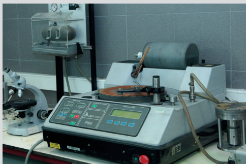
Fabrication de lames minces. © SPW-Direction de l'Édition
