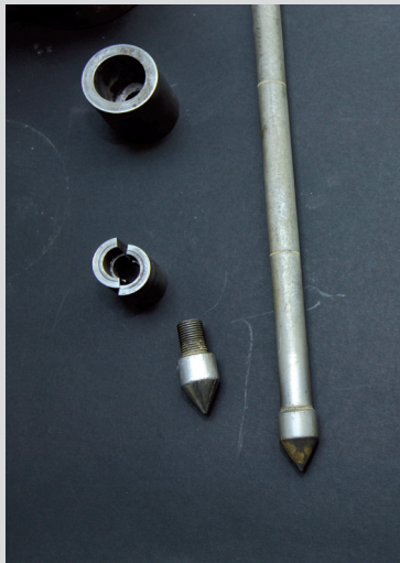
Pointe de type "Van Vuuren" - Angle de pointe 60° ; section 3,14 cm 2 © SPW-Direction de l'Édition
