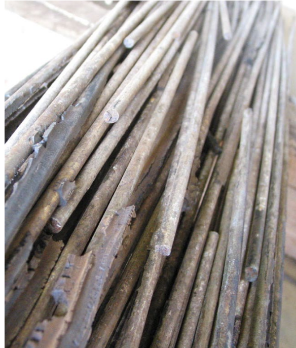
2004 – démontage du hauban défectueux Ruptures de fils repérées lors de l'expertise
