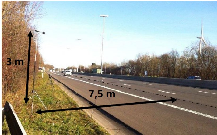
Figure 2 Mesure en partie supérieure - Illustration du positionnement d'un sonomètre
