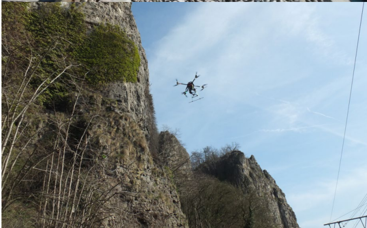
Entre Beez et Marche-les-Dames, chute d'un bloc qui, en ricochant sur la route, est arrivé sur les voies du chemin de fer. Réalisation d'une campagne de reconnaissance par drone (DGO-4).
