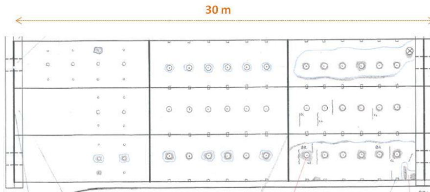
Figure 1. - Travée 7-1 du pont d'Embourg : schéma de l'état de la face inférieure du tablier
