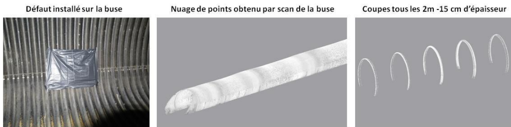
Figure 9. - Buse métallique de Chatelet : modèle de la buse réalisé par scan
