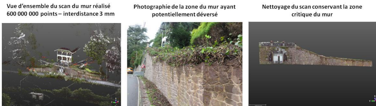
Figure 6. - Mur de Lustin : nuage de points obtenu par scanner 3D
