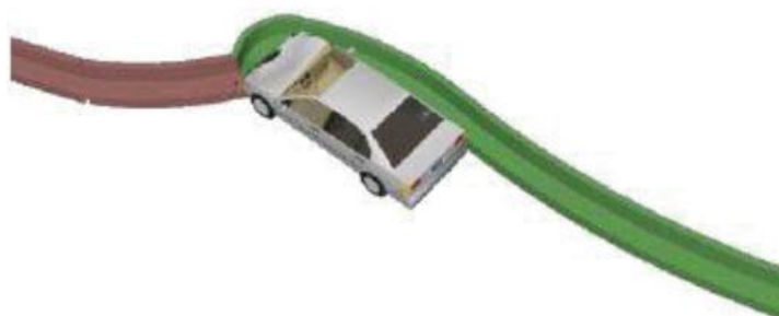
Figure 56 – Blocage d'un véhicule au niveau de la transition de deux dispositifs différents.
